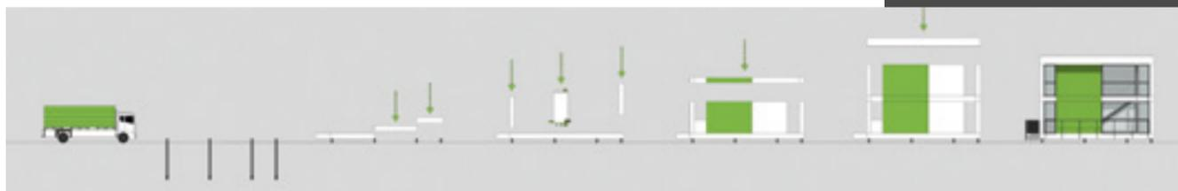
**3 préfabrication** - Les maisons so'BOIS sont préfabriquées en atelier. Cette solution industrielle est gage d'une qualité, d'une réduction de temps et de coûts de fabrication. Son impact environnemental est réduit. Une maison est ainsi préparée en atelier, ceci dès le dépôt du PC et pendant le terrassement ou les fondations. Chantier propre et sec. (CENOMANE)
