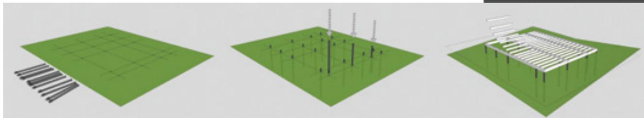
**2 fondations** - Cette maison est ancrée sur des pieux métalliques traités anti-corrosion, vissés dans le sol. Outre les avantages d'être pérennes et rapides à mettre en œuvre, cette technique s'adapte aux terrains les plus difficiles. Sur un sous-sol, les fondations sont réalisées en maçonnerie et le plancher du rez-de-chaussée reste en bois. (TECHNO-PIEUX)
